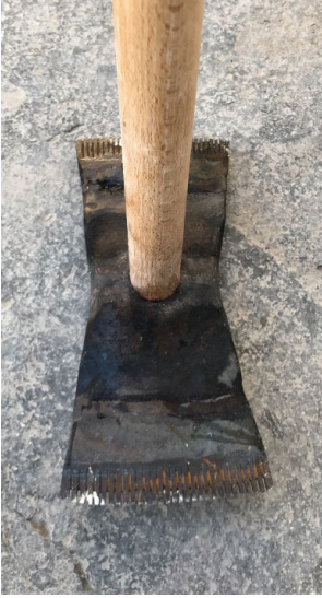
Tarak, yonacak; duvar yüzeyini raspalamaya (temizlemeye) yarar.
